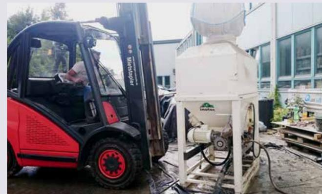
Remplissage avec big bags via deux caisses mono big bag (idéal pour une hauteur de pièce limitée, utilisable à partir de 1,80 m)
