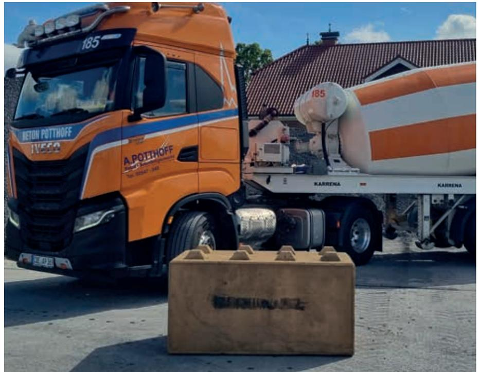
Auf dem Werksgelände in Rosendahl-Osterwick wurden Probekörper in Form so genannter Beton-Legosteine hergestellt.
