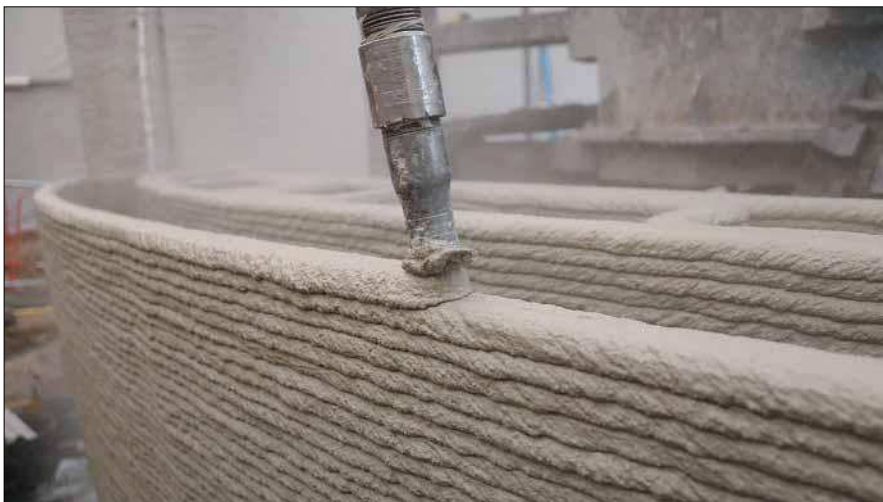
Dank des von Korodur entwickelten Baustoffs CyBe Mortar können Elemente in einem kompletten Stück gefertigt werden.
