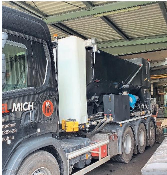
Der Lkw verfügt über mehrere Kammern und Behälter für die verschiedenen Bestandteile, die für das Anmischen des Estrichs bzw. Betons benötigt werden.
