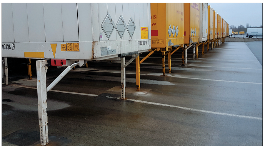
Hohe punktuelle Belastungen treten nicht zuletzt beim Abstellen von Lkw-Anhängern und Containern auf.
