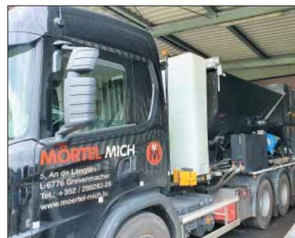
*Der Lkw von Mörtel Mich verfügt über mehrere Kammern und Behälter für die verschiedenen Bestandteile, die für das Anmischen des Estrichs bzw. Betons benötigt werden.*
