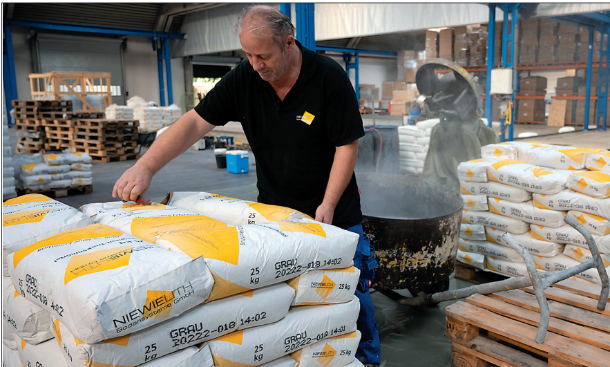
Der Magnesit-Estrich wird gemäß der von Niewielith vorgegebenen Rezeptur bei Korodur in Bochum-Wattenscheid fertig gemischt und als Sackware angeliefert. So ist gesichert, dass jede Charge genau dieselben Produkteigenschaften bietet.
