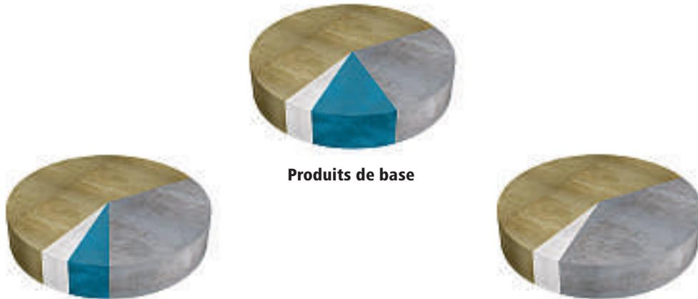
Produits de réaction du **ciment : le ciment Portland** est hydraté avec E/C = 0,25
